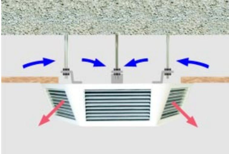
Калориферы, предназначенные для монтажа на потолке с использованием режима циркуляции воздуха или для монтажа на подвесном потолке с использованием режима циркуляции или перемешивания воздуха.
